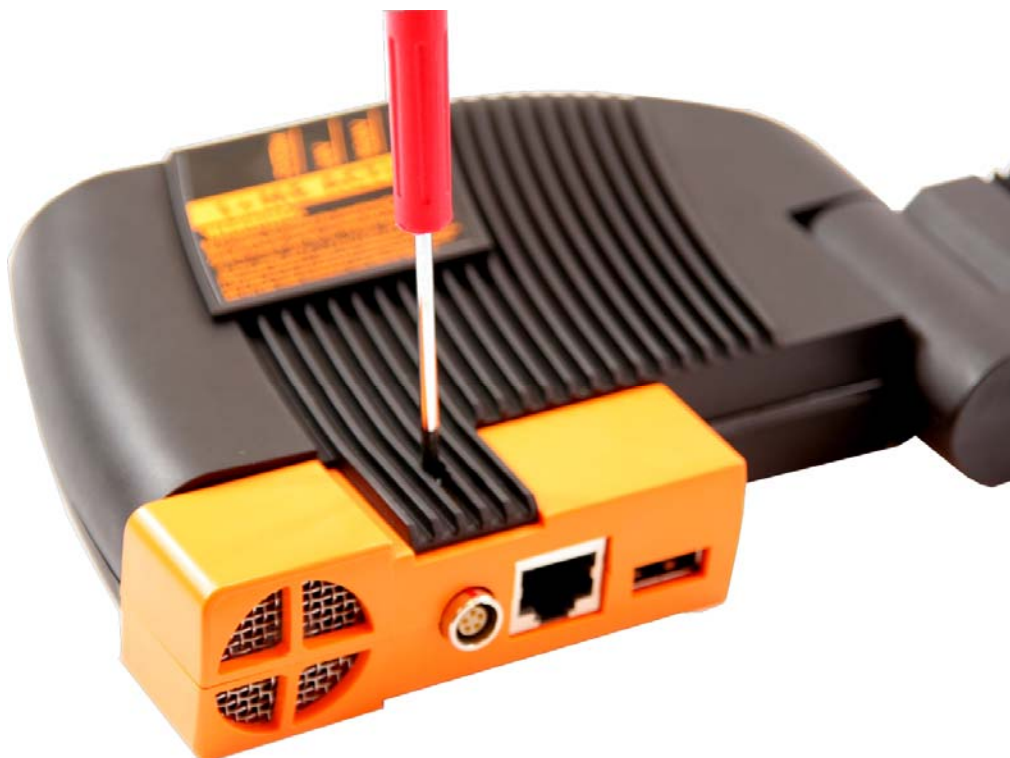
Рис. 16 Вывинчивание/завинчивание фиксирующего винта
