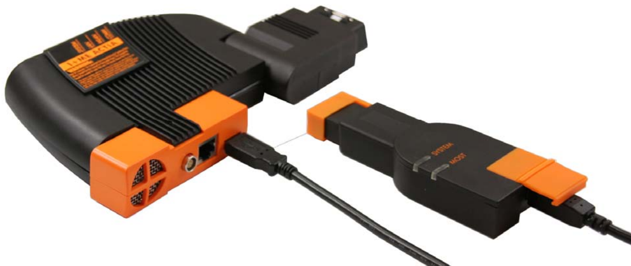
Рис. 10 Соединение ICOM A с B
